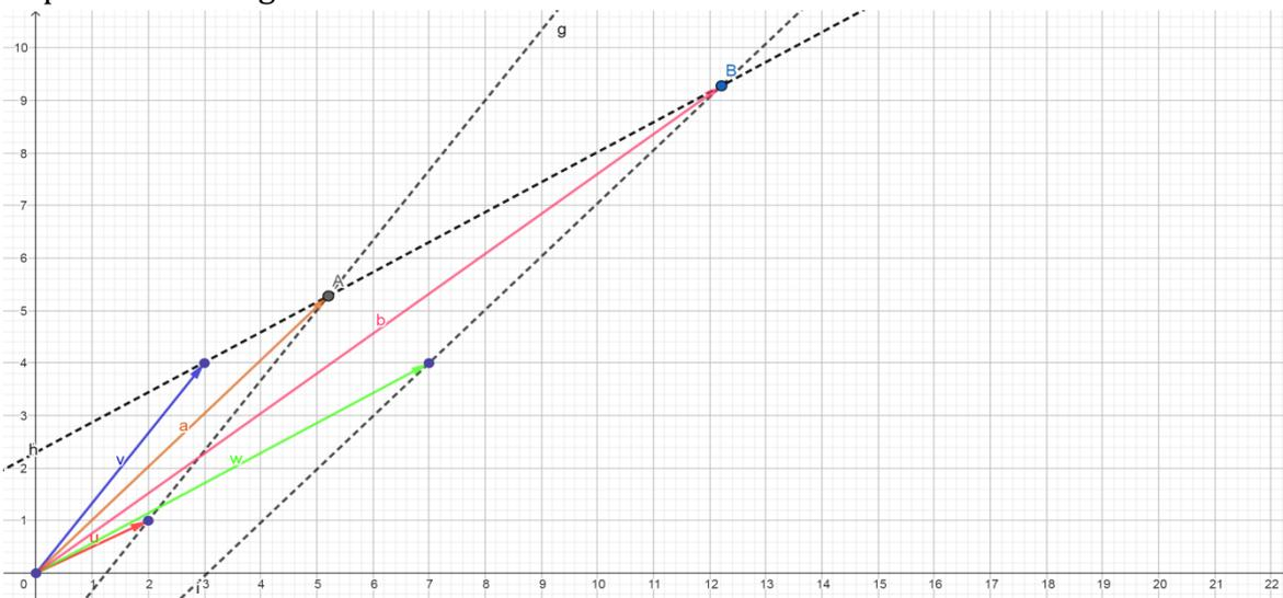
Somma del vettore  $A$  con il vettore  $W$  per ottenere il vettore risultante  $B$ .
