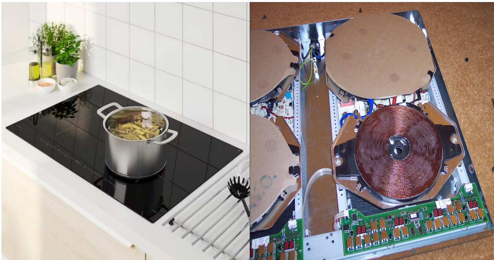
Esterno ed interno di un piano cottura ad induzione elettromagnetica.
